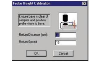
2. Выберите «Return Distance» (Расстояние хода) и «Speed» (скорость), с которой вы хотите, чтобы работал зонд, и точку возврата зонда после контакта с поверхностью (0мм).
