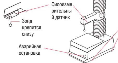
Проверьте, чтобы опоры были прочно закреплены и TA.XTplus стоял ровно
