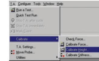
1. Из Панели инструментов, выберите «T.A.>Calibrate>Calibrate Height» (откалибровать высоту).
