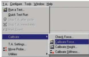
1. Из меню Панели инструментов, выберите «T.A.>Calibrate>Calibrate Force» (Откалибровать усилие).
