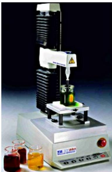
**Анализ текстуры** представляет собой исследование структурно-механических свойств образцов путем испытания на сжатие, разрез, надламывание, прокол растяжение, пенетрацию и т.
