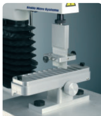
Включает пластину с несколькими щелями и зажим и предназначен для измерения силы адгезии, например, материала поверхности и клейкой ленты. (Используется с системой для определения индекса адгезии)
