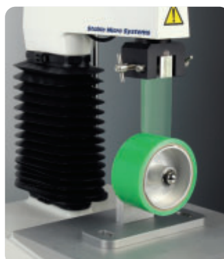
Позволяет измерять силу адгезии при разматывании рулона с клейкой лентой.
