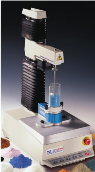
Испытательная машина компании **Stable Micro Systems** (Англия) позволяет проводить точные и достоверные измерения характеристик сыпучести и степени сжатия порошковых катализаторов.
